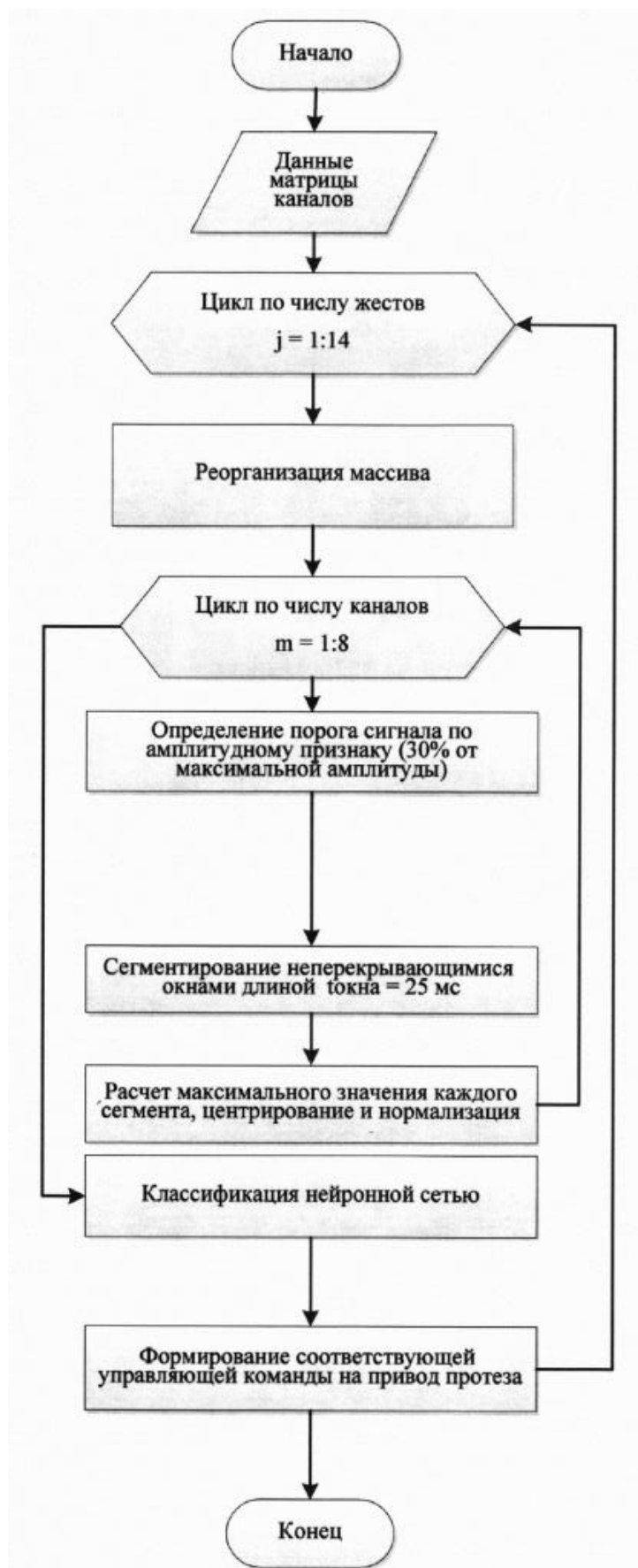
Рис. 2 – Пример осуществления обработки сигнала от системы считывания. Для каждого сегмента вычисляется его максимальное значение по формуле:
