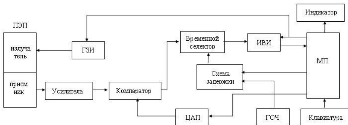
Рис. 1 – Структурная схема устройства для ультразвуковой дефектоскопии
