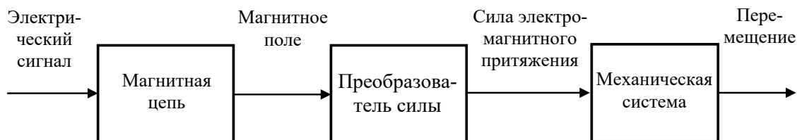
Рис.2. – Обобщенная структурная схема процесса работы электромагнита
