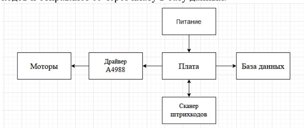
Рис. 3 – структурная схема устройства
