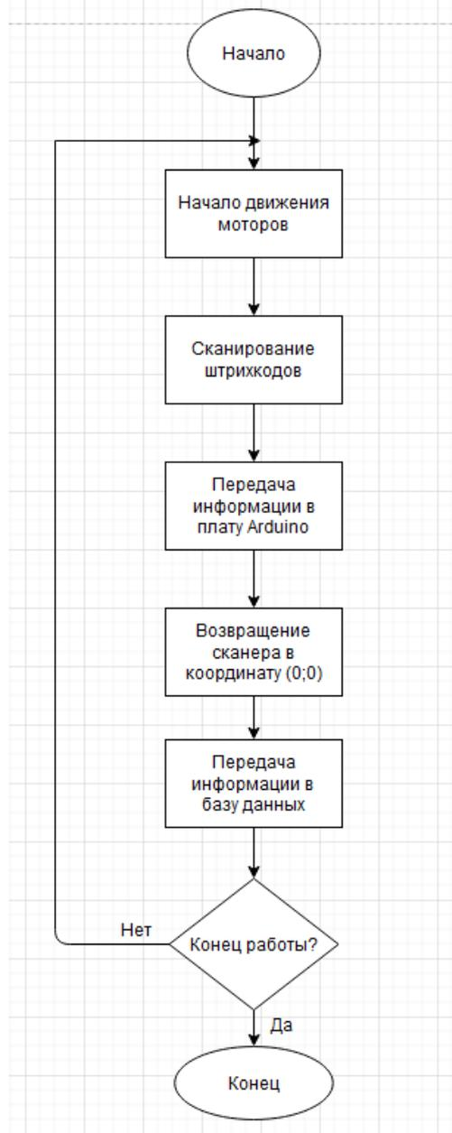
Рис.5 – Алгоритм работы устройства
