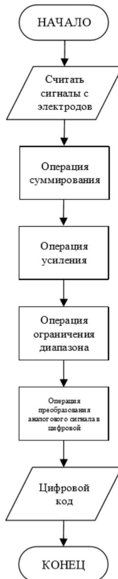
Рис.2- Алгоритм функционирования вычислительного блока
