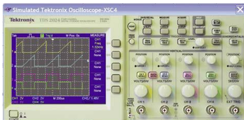
Рис. 2 – Диаграммы сигналов на выходах интеграторов и триггера
