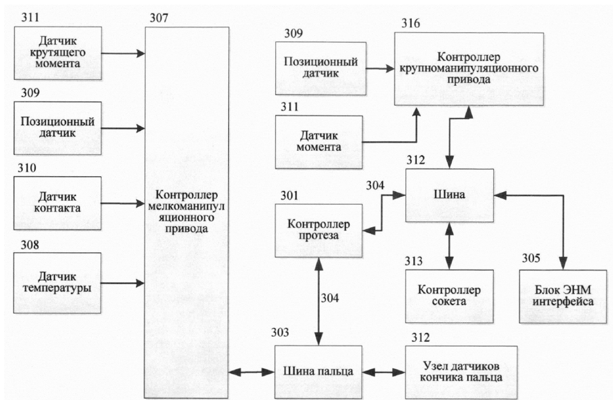
Рис.3 - Блок-схема реализации системы управления интеллектуальной бионической конечностью
