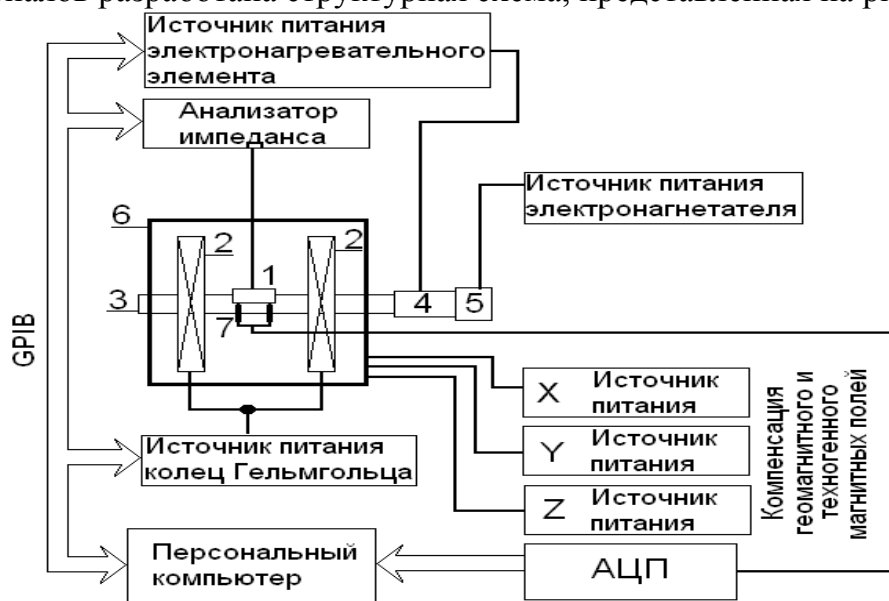
Рис. 1 – Структурная схема разрабатываемого устройства для измерения магнитного импеданса
